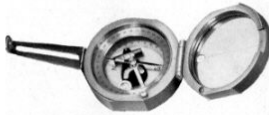
Abb. 11 Bruntonkompass Kurzwort: „Brunt“, Kat.-Nr. 0480
