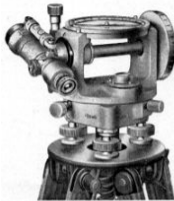
Abb. 14 Bergbussole Kurzwort: „Berbu“, Kat.-Nr. 0470
